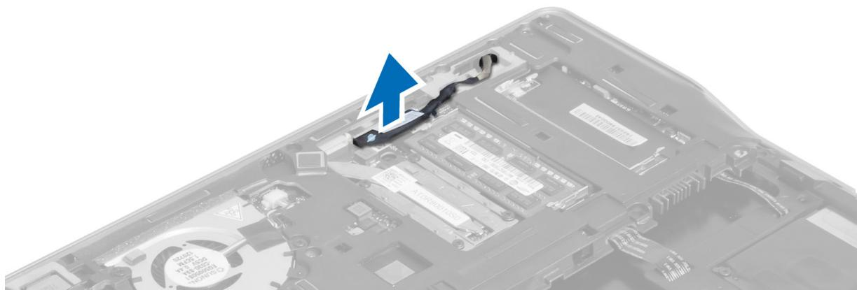
4. 断开天线电缆与无线解决方案的连接。
