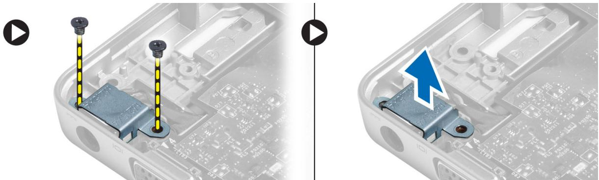
6. 拧下将系统板固定至计算机的螺钉并将其卸下。
