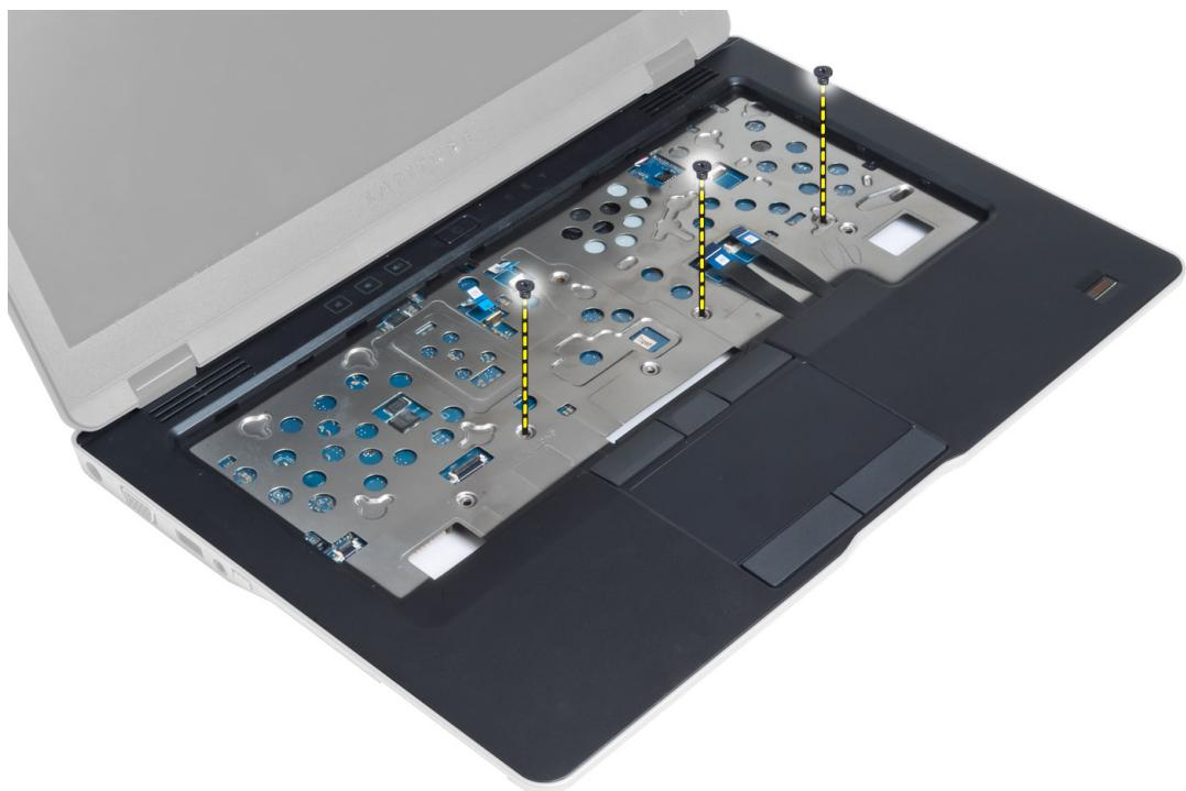
5. 将计算机翻转过来，拧下将掌垫部件固定至计算机基座的螺钉，然后翻转打开下部部件。
