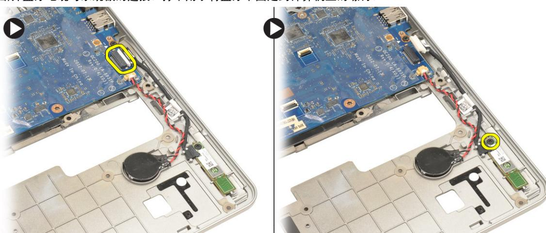
4. 卸下蓝牙卡。断开电缆与插卡的连接。
