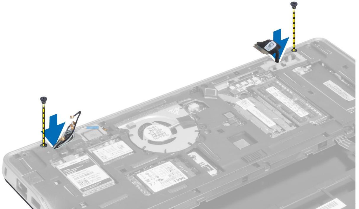
6. 拧下将显示屏部件固定至计算机的螺钉，将显示屏部件从计算机中提起。
