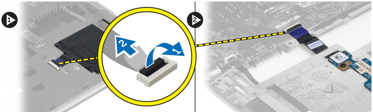
4. 拧下将智能卡板固定到位的螺钉。将智能卡电缆从布线通道中拔下，然后将智能卡从计算机卸下。
